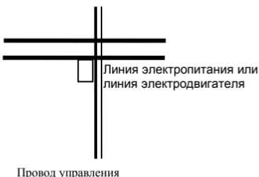
Рис. 3-16 Требования к прокладке проводов
