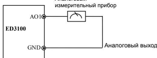
Рис.3-12 Подключение к клемме аналогового выхода
