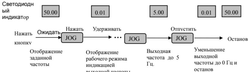
Рис.4-9 Пример управления в толчковом режиме
